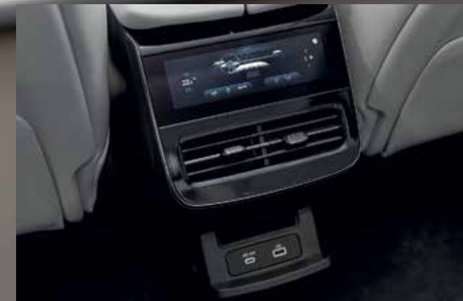
Многофункциональный дисплей для пассажиров заднего ряда с функцией управления климат-контролем, аудиосистемой, сдвижным люком и солнцезащитной шторкой панорамной крыши, а также подогревом сидений
