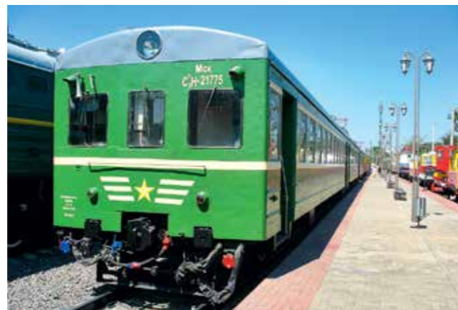
2 Секция C_3 появилась в 1952 году и была рассчитана только на работу с напряжением 3000 В
