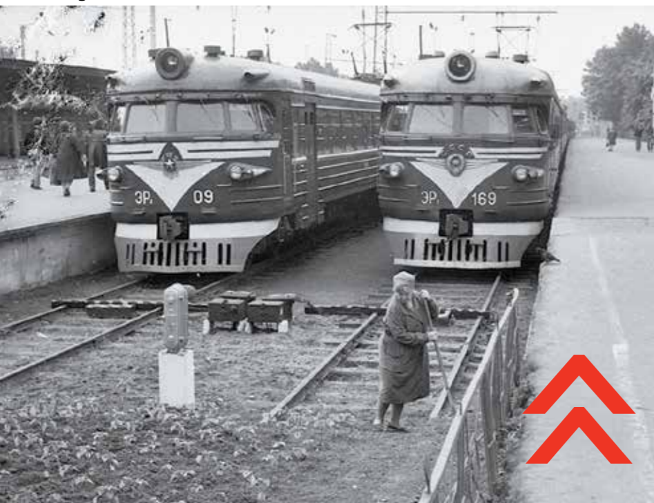
3 Электропоезд постоянного тока ЭР1 стал первой моделью из нового семейства ЭР, которое выпускал Рижский вагоностроительный завод
