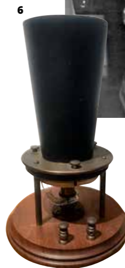
5 Первые телефоны Белла снабжались инструкцией: «Не слушайте ртом и не говорите ухом», чтобы абоненты не путались в положении трубки 6 В воду внутри жидкостного передатчика для повышения электропроводности добавляли кислоту
