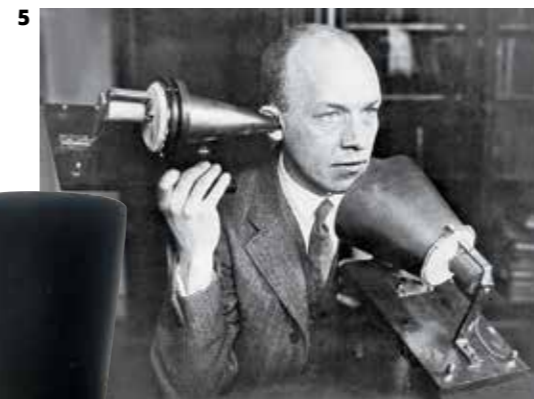
5 Первые телефоны Белла снабжались инструкцией: «Не слушайте ртом и не говорите ухом», чтобы абоненты не путались в положении трубки 6 В воду внутри жидкостного передатчика для повышения электропроводности добавляли кислоту
