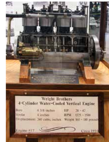
3 Двигатель внутреннего сгорания, который братья Райт использовали для своего первого самолета
